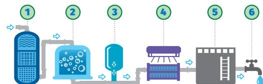
1. Las torres de extracción de aire eliminan los VOCs por debajo de los niveles de detección.
